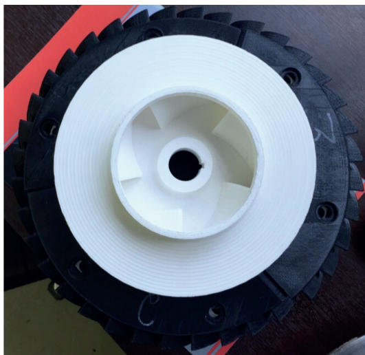
Рис. 5. Элементы проточной части после 3D-печати
