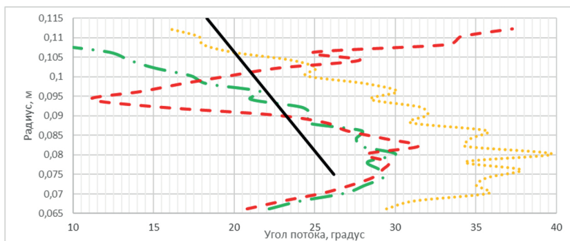
Рис. 8. Углы потока от радиуса для 1-го варианта ( 0.75 Q_{\text{НОМ}} – красная штриховая, Q_{\text{НОМ}} – зелёная штрихпунктирная, 1.25 Q_{\text{НОМ}} – жёлтая точечная; углы установки лопасти РК – черная сплошная)
