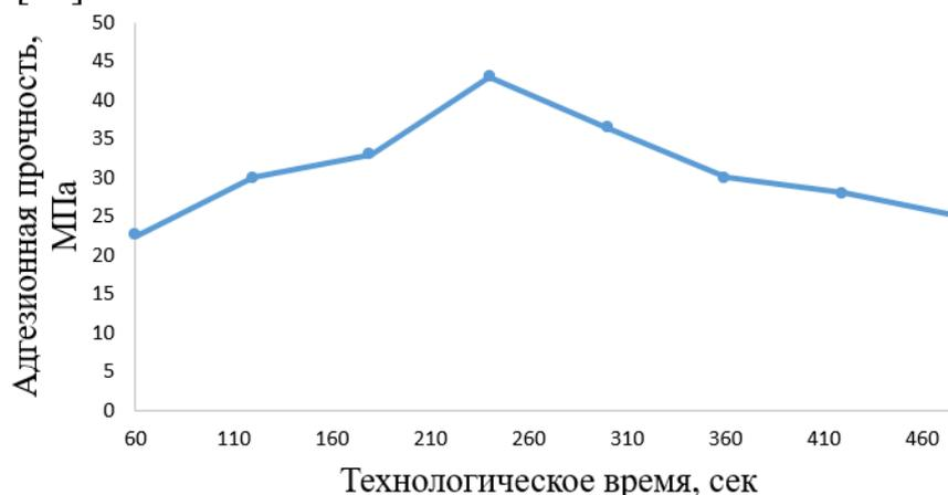
**Рис. 2.** Влияние на адгезионную прочность соединения полиамидных покрытий и стали после выдержки при технологической температуре 570 К.
