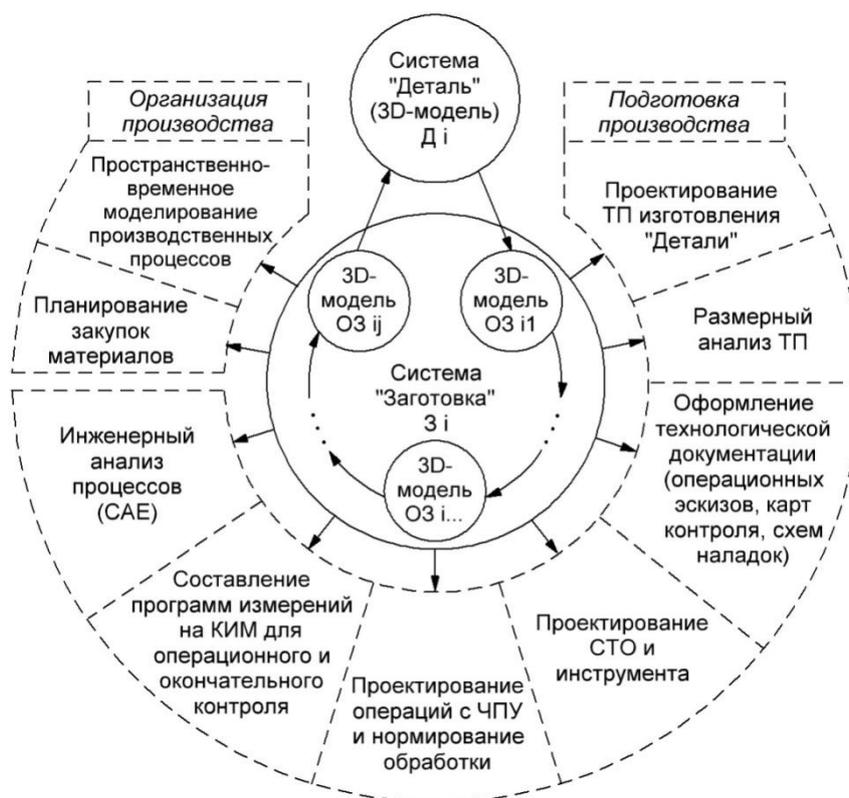
**Рис. 1.** Интегрирующая роль 3D-моделей операционных заготовок при подготовке и организации производства [2]
