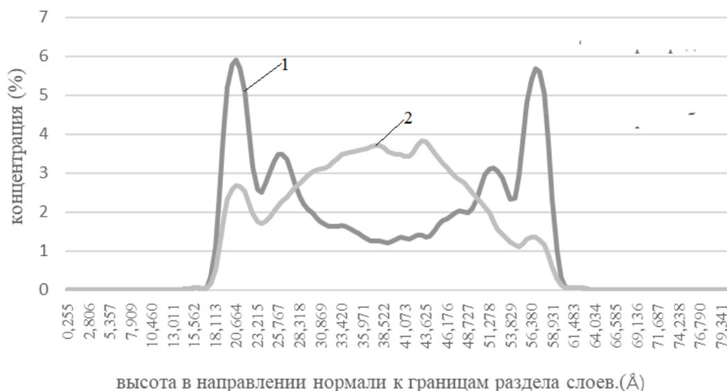
**Рис. 2.** Распределение концентрации ПТФЭ в направлении нормали к границам раздела слоев: 1 – при предельном состоянии до изнашивания; 2 – при свободном состоянии
