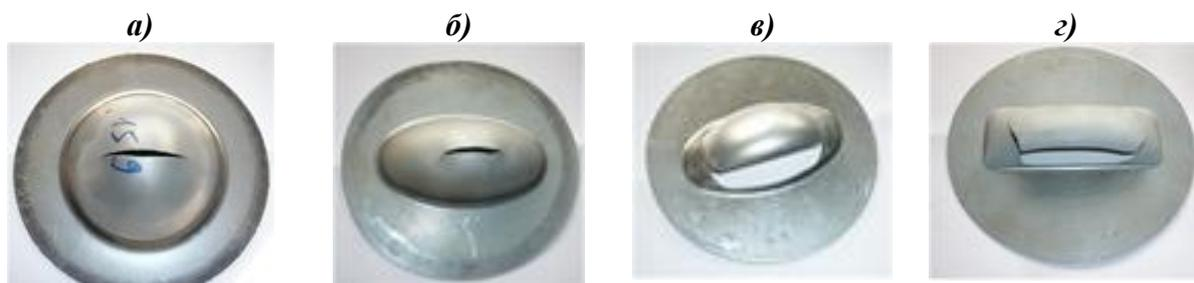
**Рис. 2.** Примеры образцов после импульсного VPF теста: *а, б* – валидные испытания, *в, з* – не валидные испытания
