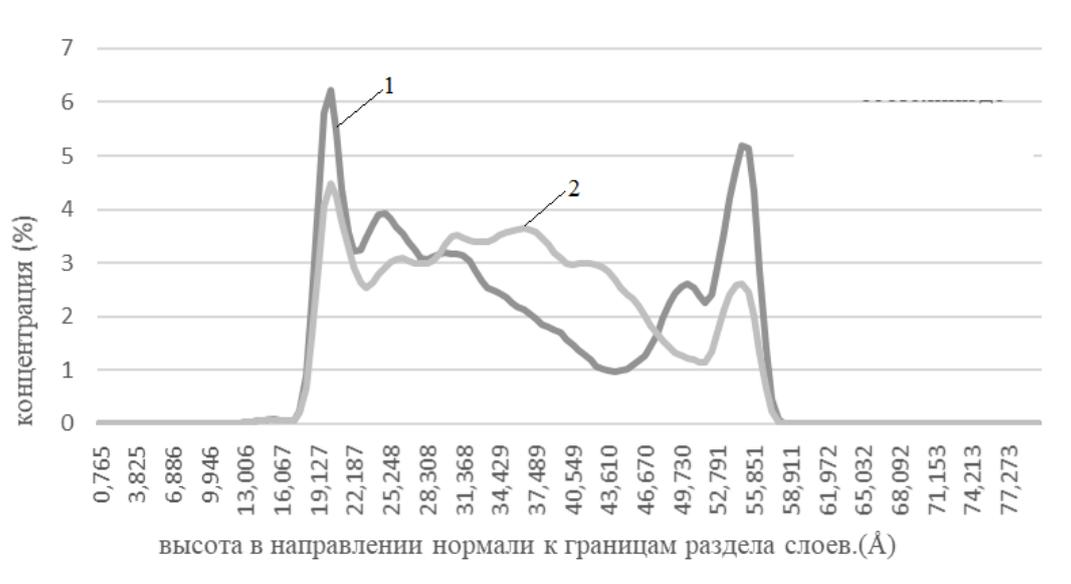
**Рис. 4.** Распределения концентрации Ф4К20 в направлении нормали к границам раздела слоев: 1- при предельном состоянии до изнашивания; 2 – при свободном состоянии.
