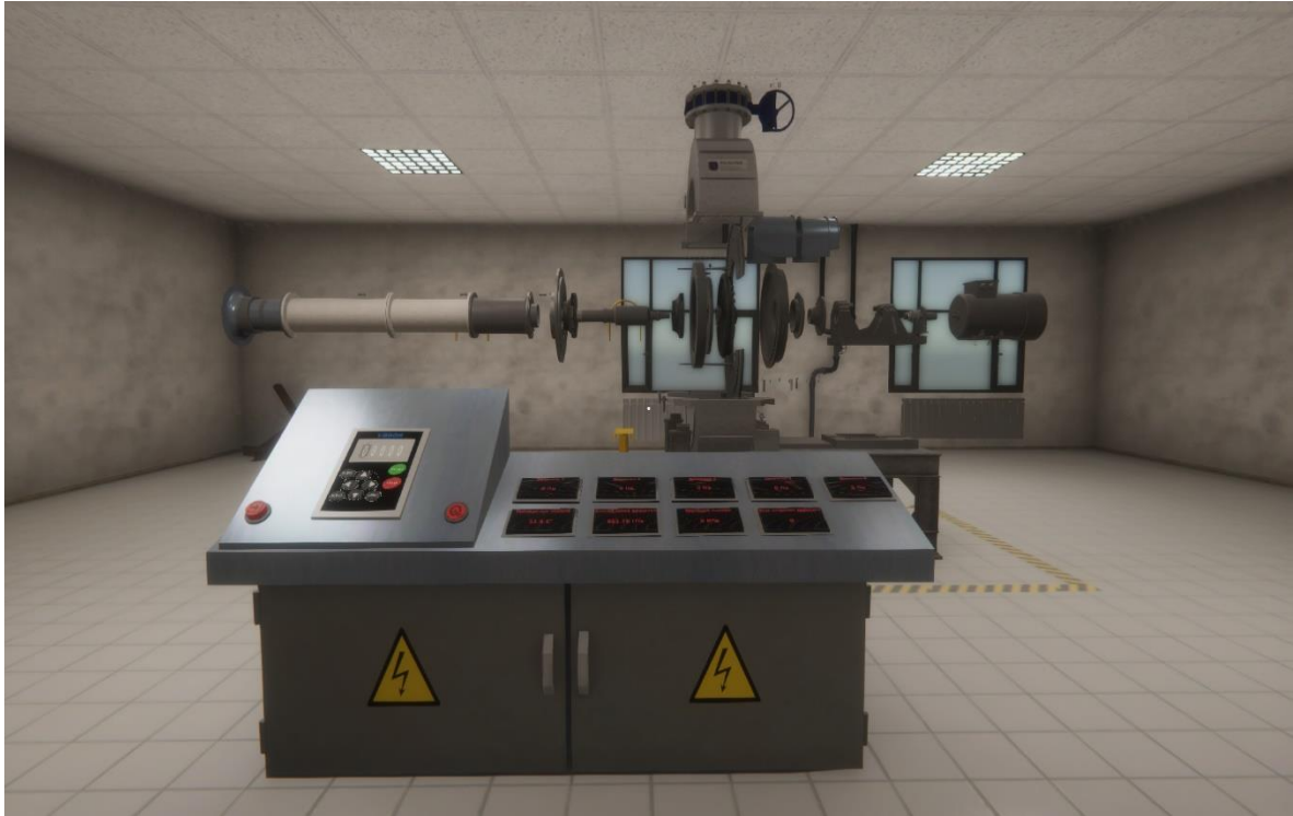
Рис. 2. Центробежный компрессор и пульт управления
