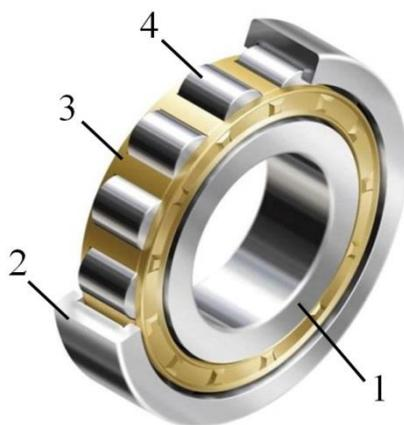
**Рис. 1.** Устройство подшипника качения: 1 – внутреннее кольцо, 2 – внешнее кольцо, 3 – сепаратор, 4 – тело качения
