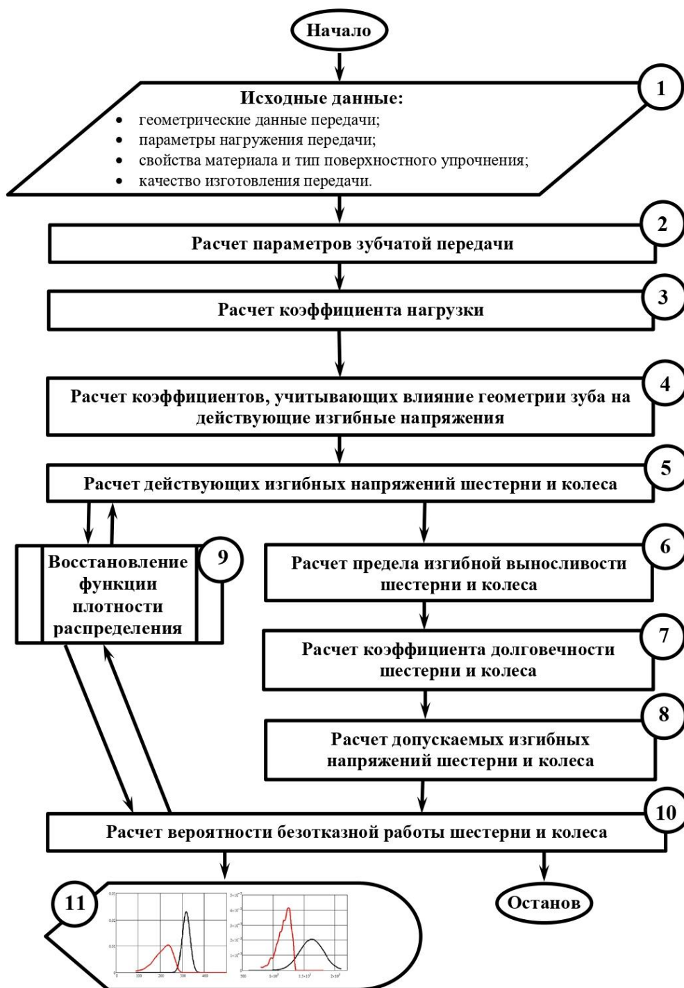
Рис. 2. Блок-схема методики расчета вероятности безотказной работы зубчатой передачи по критерию изгибной выносливости
