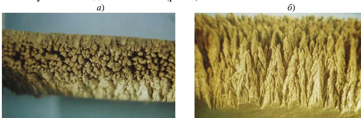
**Рис. 8.** «Горная» структура эродированной поверхности лопатки турбины: а) в поперечном; и б) продольном сечении относительно направления движения капли. х40.
