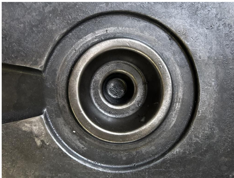
Рис. 3. Отсутствие следов износа на ручье штампа после изготовления запланированной партии поковок
