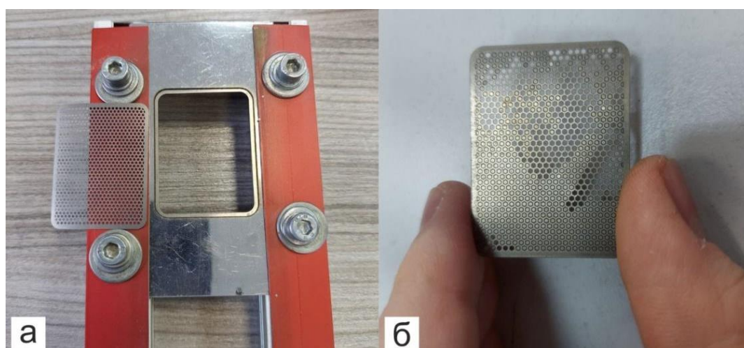
Рис. 8. Перфорация титана с толщиной 0,3 мм. Отверстия – шестиугольник размеров 0,8 мм
