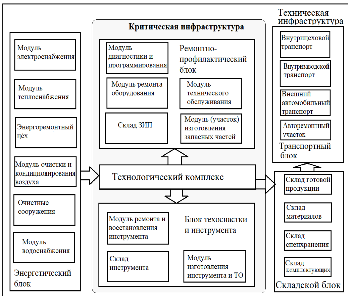
Рис. 2. Функциональная модель технической инфраструктуры предприятия.
