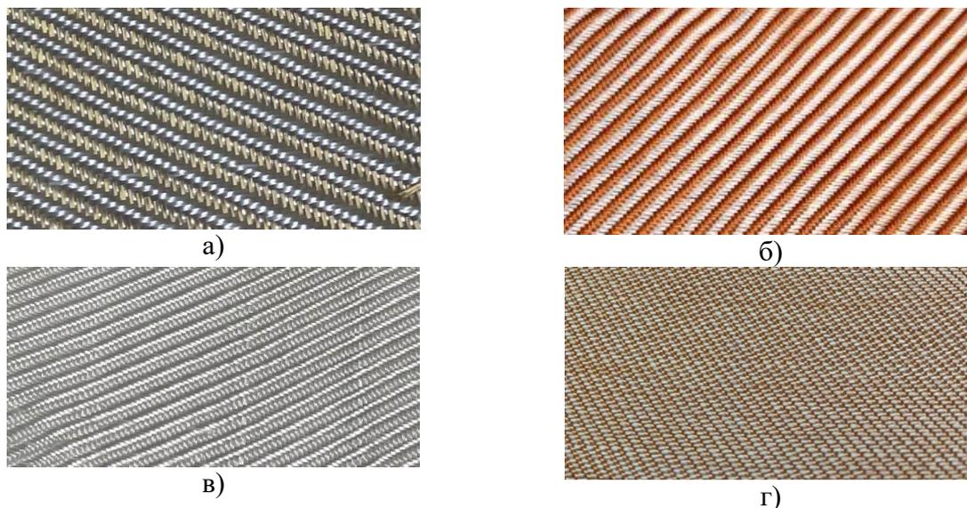
Рисунок 1 - Внешний вид образцов гибридных тканей: а) ткань из стеклянных нитей и нитей СВМ, б) ткань из стеклянных нитей и полиоксидазольных нитей марки «Арселон», в) ткань из стеклянных нитей и нитей СВМПЭ, г) ткань из нитей СВМ и полиамидных нитей
