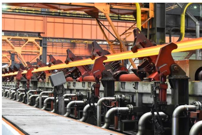
Рисунок 1 – Технологическая линия термообработки рельсов
