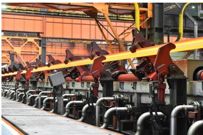
Рисунок 1 – Технологическая линия термообработки рельсов
