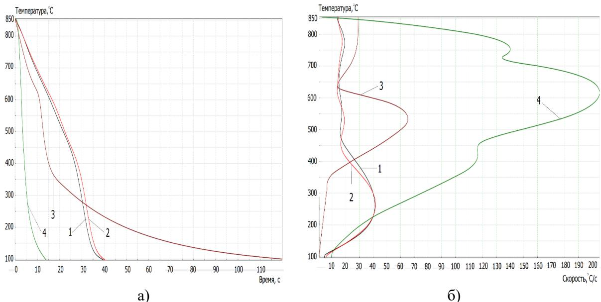
Рисунок 1 - Кривые охлаждения закалочных жидкостей: а) «температура-время»; б) «температура-скорость» 1 - «Росойл-51», 2 - «Feroquench», 3 – Закалочное масло «МЗМ-16», 4 – Вода.
