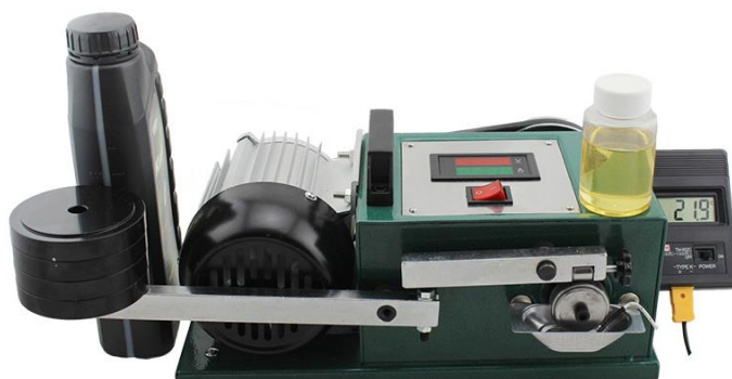
Рисунок 1- Внешний вид трибометра для испытаний противоизносных свойств смазочных материалов по методу Райхерта.
