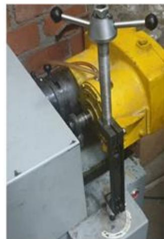
Рисунок 3 – а) Зависимость интенсивности изнашивания  $I$ , г/м от давления диска  $P$ , МПа (скорость скольжения диска 2 м/с): 1 – Hastelloy X, 2 – AlCoCrCuFeNi + B4CCoMo, 3 – AlCoCrCuFeNi + cBNCoMo, 4 – NiCoTiZrHf + cBNCoMo; б) фотография испытания на фрикционный износ
