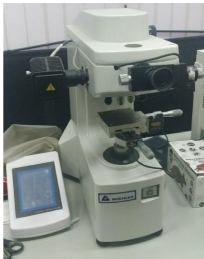
Рисунок 2 – Микро-твердомер Buehler MicroMet 5103 с индентором Виккерса
