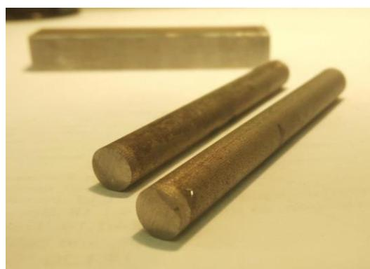
Рисунок 7 - Внешний вид вырезанных образцов с наплавкой. Пример.
