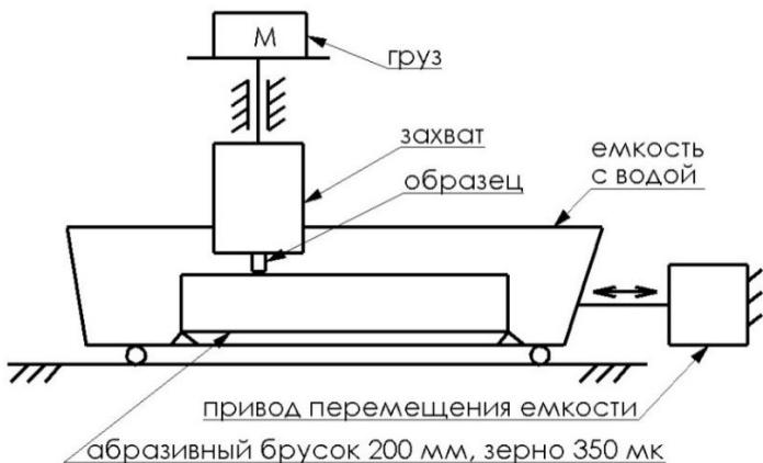
Рисунок 5 - Схема испытания на машине МТВП
