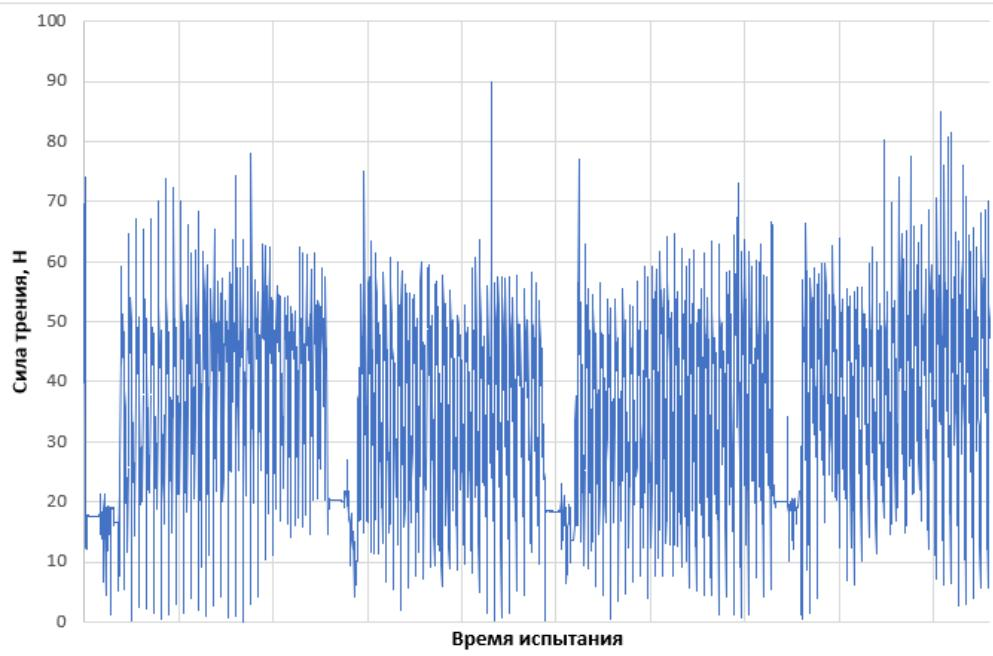
Рисунок 10 - Пример диаграммы силы трения от времени при испытании образца КСС-3 (образец 2). Время испытания 60 мин (4 периода по 15 мин).
