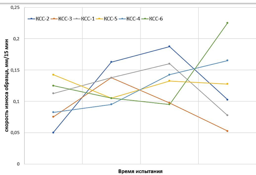
Рисунок 8 - Зависимость скорости износа образцов от времени испытания. Общая длительность испытания каждого образца 60 мин.
