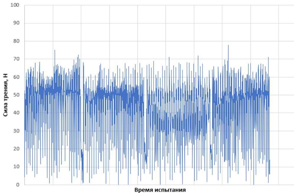
Рисунок 11 - Пример диаграммы силы трения от времени при испытании образца КСС-5 (образец 6). Время испытания 60 мин (4 периода по 15 мин).
