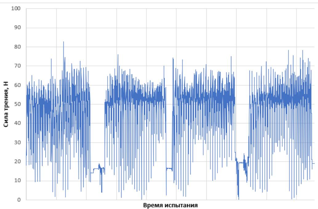
Рисунок 9 - Пример диаграммы силы трения от времени при испытании образца КСС-2 (образец 1). Время испытания 60 мин (4 периода по 15 мин).
