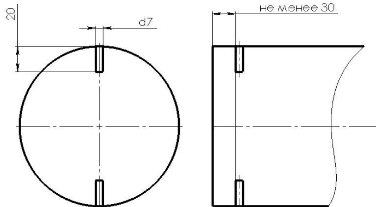
Рисунок. 3 - Вырезка образцов для трибологических испытаний
