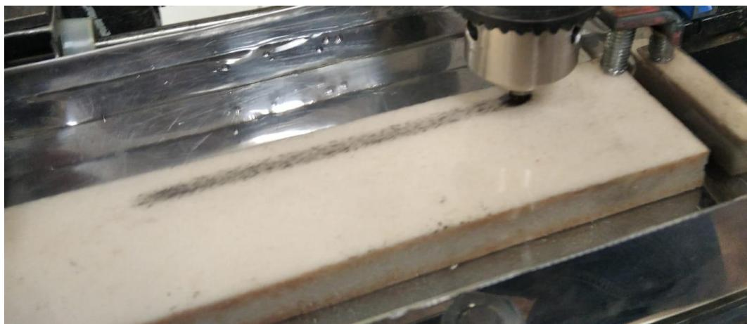
Рисунок 6 - Установленный на машине МТВП абразивный брускок из оксида алюминия в ванне под слоем чистой воды. Первые 5 минут испытания образца.
