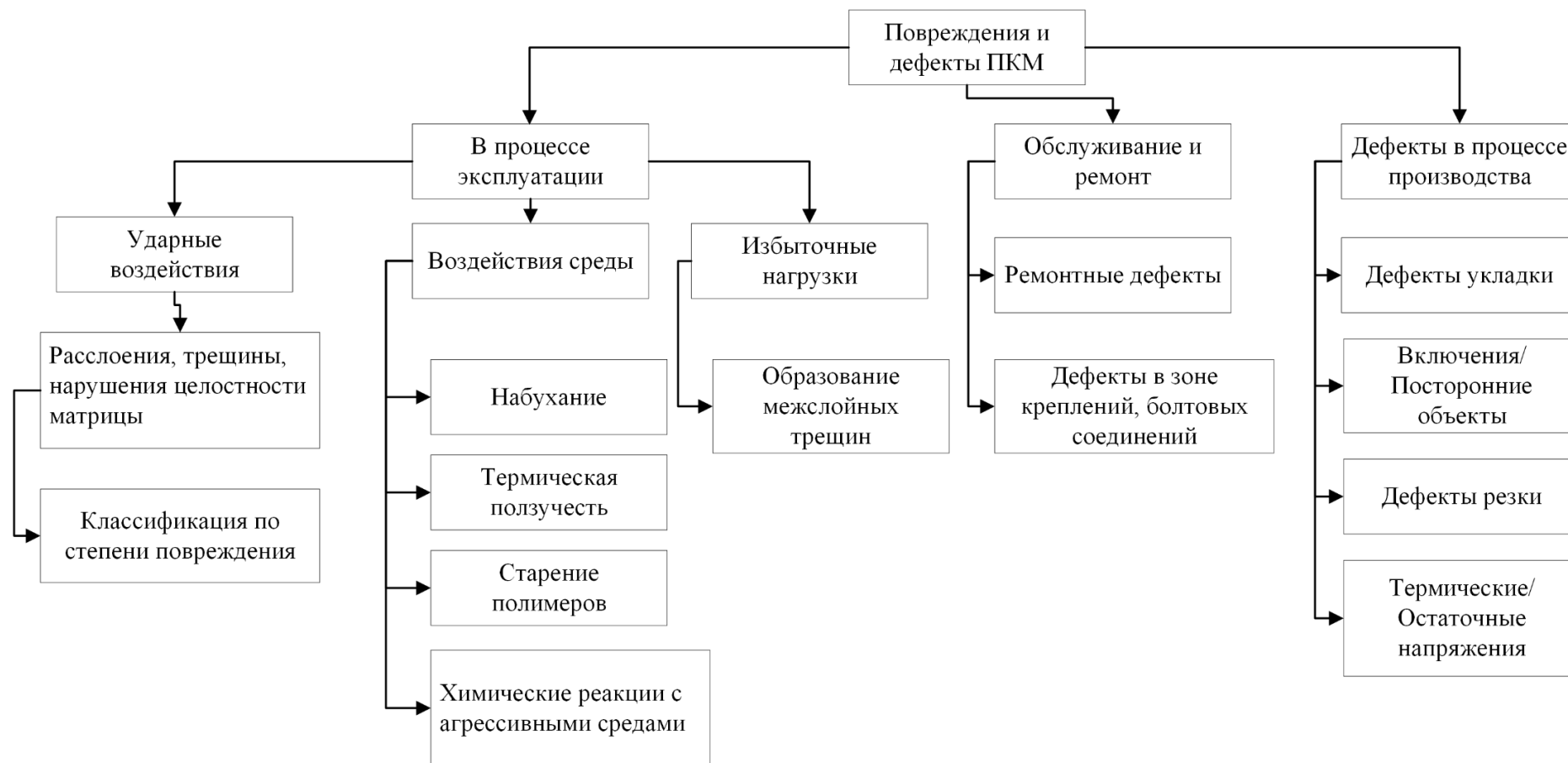
Рисунок 1 – Схема возможных причин зарождения дефектов в полимерных композиционных материалах
