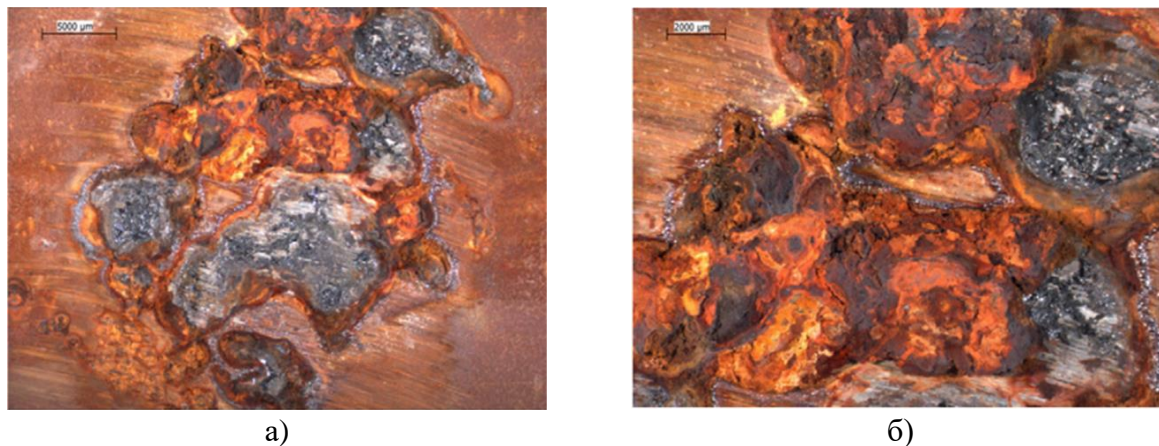
Рисунок 1 – Изображения продуктов коррозии на поверхности металла: а) общий вид; б) детальный вид коррозионного износа. (а) x5; (б) x10.
