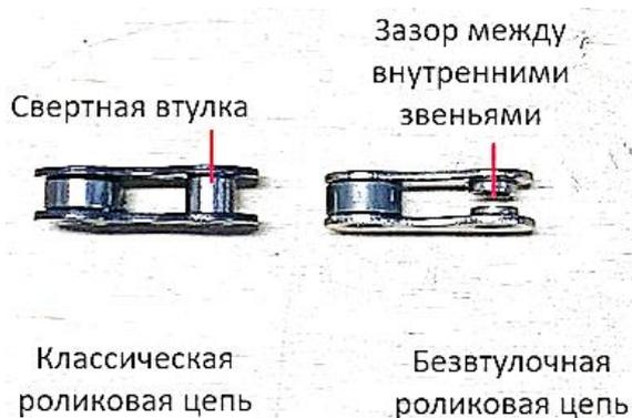
Рис. 6 Зазор между внутренними звеньями безвтулочной цепи.
