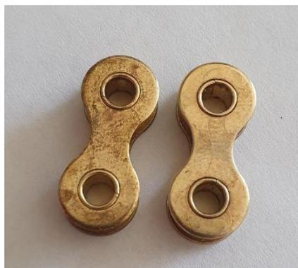
Рис.3 Произвольное расположение стыков свертываемых втулок в цепи IZUMI
