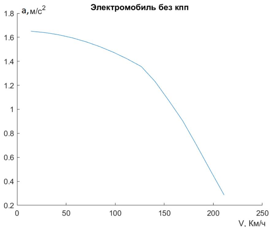
Рисунок 6 - Зависимость ускорения  $a$  от скорости электромобиля с фиксированным числом передач.
