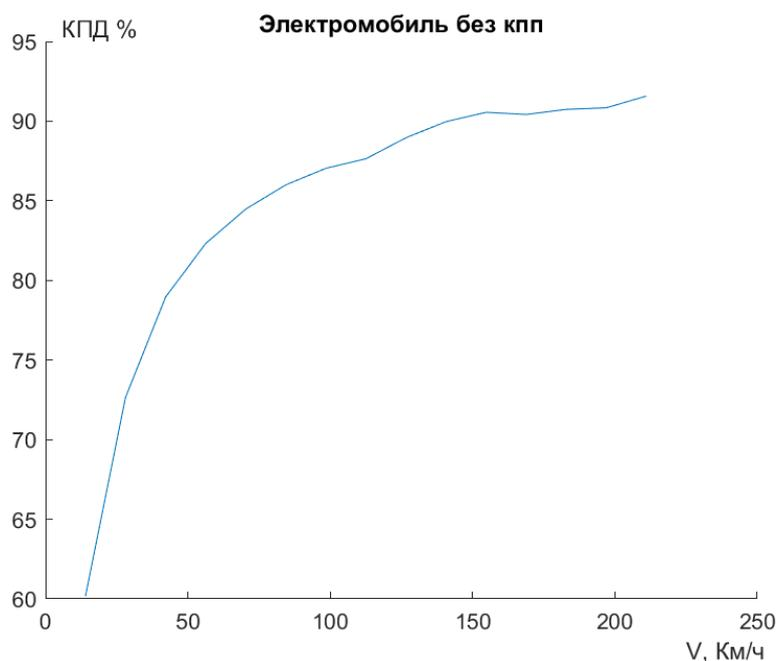
Рисунок 4 - Зависимость КПД электродвигателя от скорости  $V$  движения электромобиля с фиксированным числом передач
