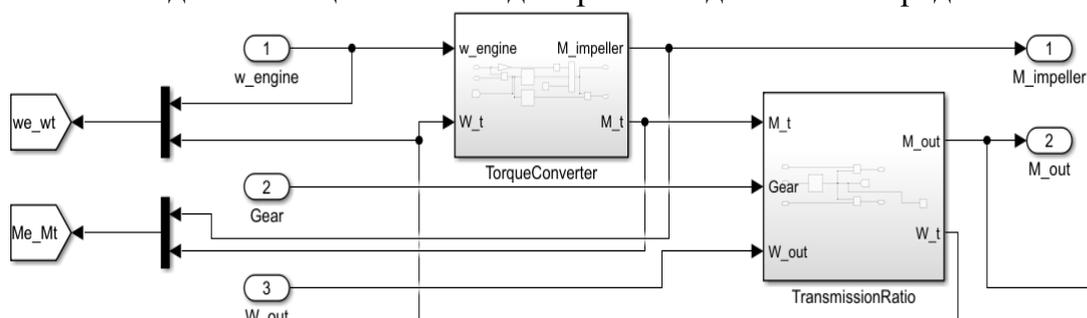
Рисунок 1 – Фрагмент схемы трансмиссии для симуляции движения в среде Simulink.
