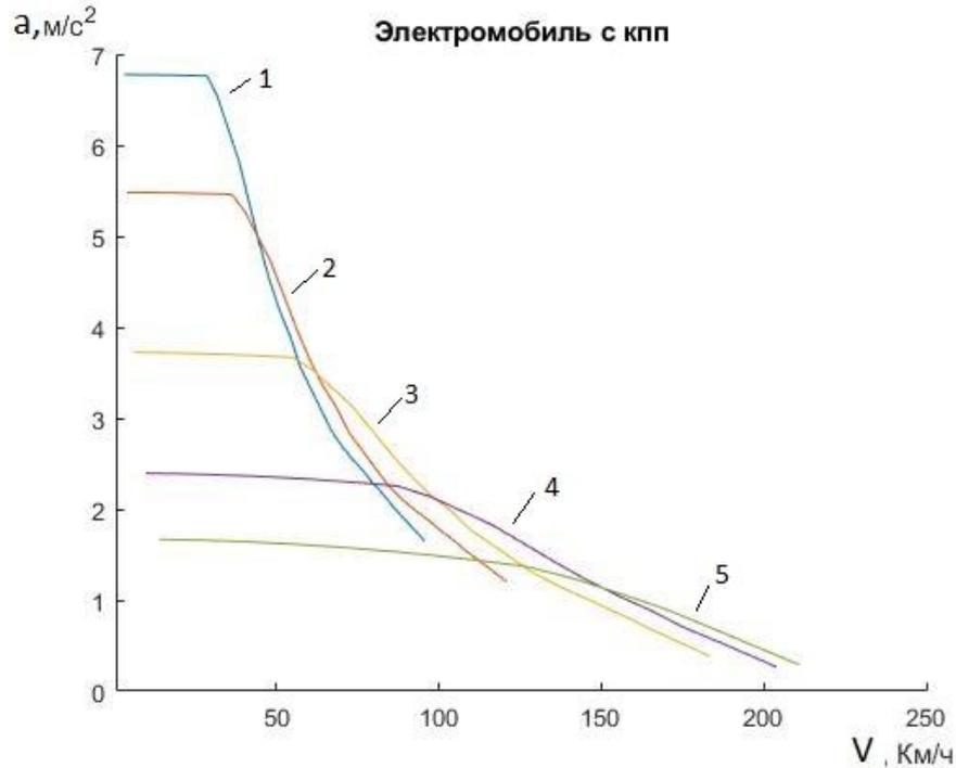
Рисунок 5 – Зависимость ускорения  $a$  от скорости электромобиля с КПП имеющей 5 передач: 1 – первая передача; 2 – вторая передача; 3 – третья передача; 4 – четвертая передача; 5 – пятая передача;
