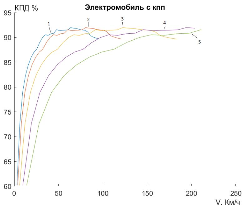
Рисунок 3 - Зависимости КПД электродвигателя от скорости  $V$  движения электромобиля с КПП имеющей 5 передач: 1 – первая передача; 2 – вторая передача; 3 – третья передача; 4 – четвертая передача; 5 – пятая передача;
