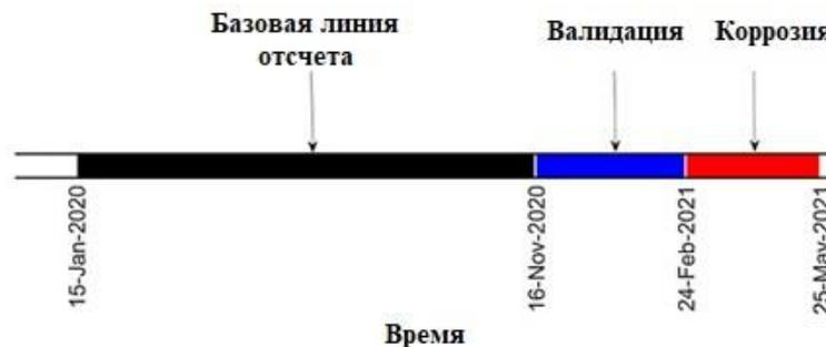
Рисунок 4 – Хронология испытания в коррозионной среде рулевой тяги с коэффициентом модального затухания  $\xi=5/8L$
