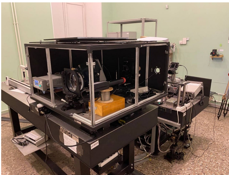
Рис. 1. Комплекс для воспроизведения, хранения и передачи размера единицы температуры в диапазоне от 961,78 °С до 3200 °С
