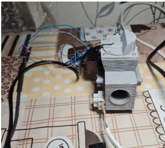
Рис. 2. Физическая модель камеры датчика с платой управления Arduino Nano [3]
