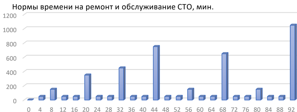
Рис. 1. Изменение времени для ремонта и технического обслуживания сложных технических объектов в зависимости от сроков их эксплуатации (расчеты автора на основе имитационной модели)
