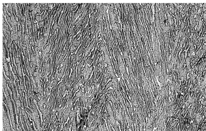
Рис. 1. Микроструктура титанового сплава ПТ-3В в исходном состоянии, глобулярная структура (увеличение \times 5000 )
