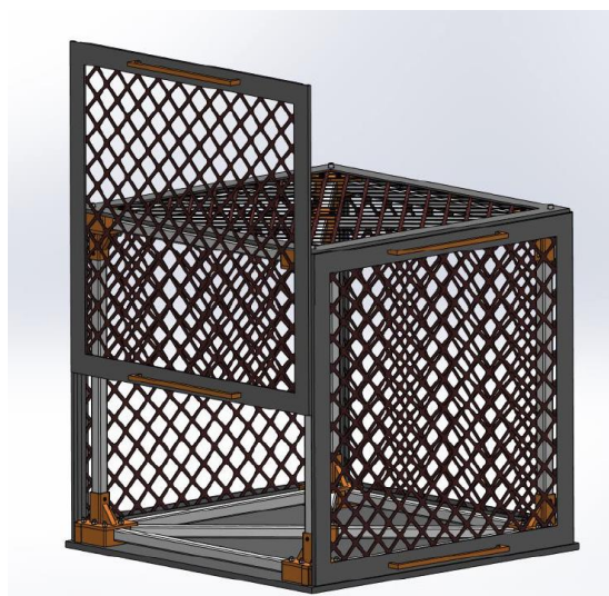
Рис. 3. Каркасная конструкция с надетыми защитными сетками
