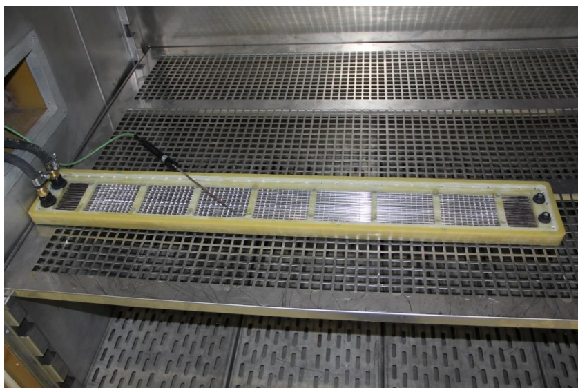
Рис. 3. Макет теплового аккумулятора в камере тепла и холода
