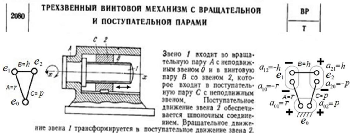
Рис. 1.1. Структурные модели винтового механизма
