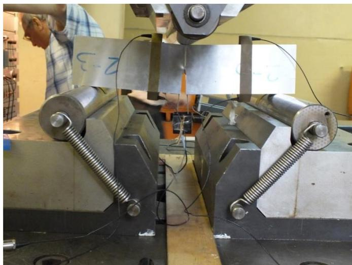
**Рис. 3.** Образец в захватах машины Инстрон.
