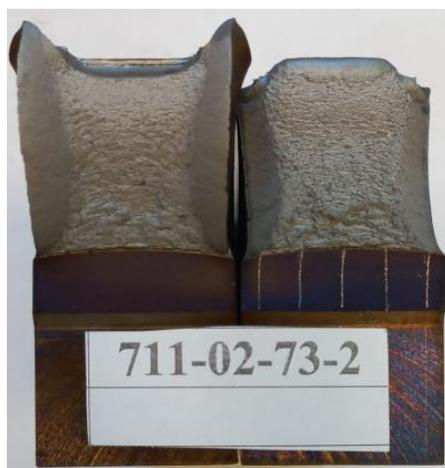
**Рис. 4.** Фото излома образца Линейный подрост трещины 0,26 мм.
