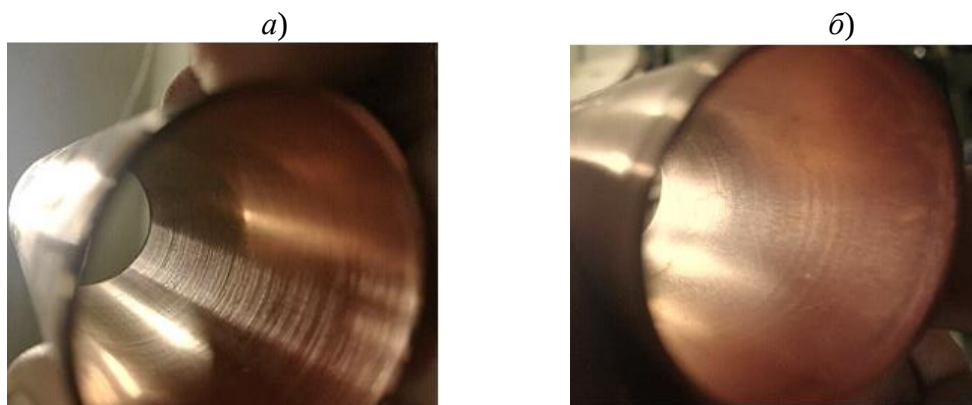
Рис. 12. Шероховатость поверхности: а) до обработки, б) после обработки.
