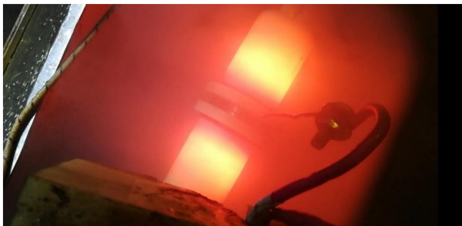
Рис. 7. Процесс ПЭПП внутренней поверхности детали-образца.
