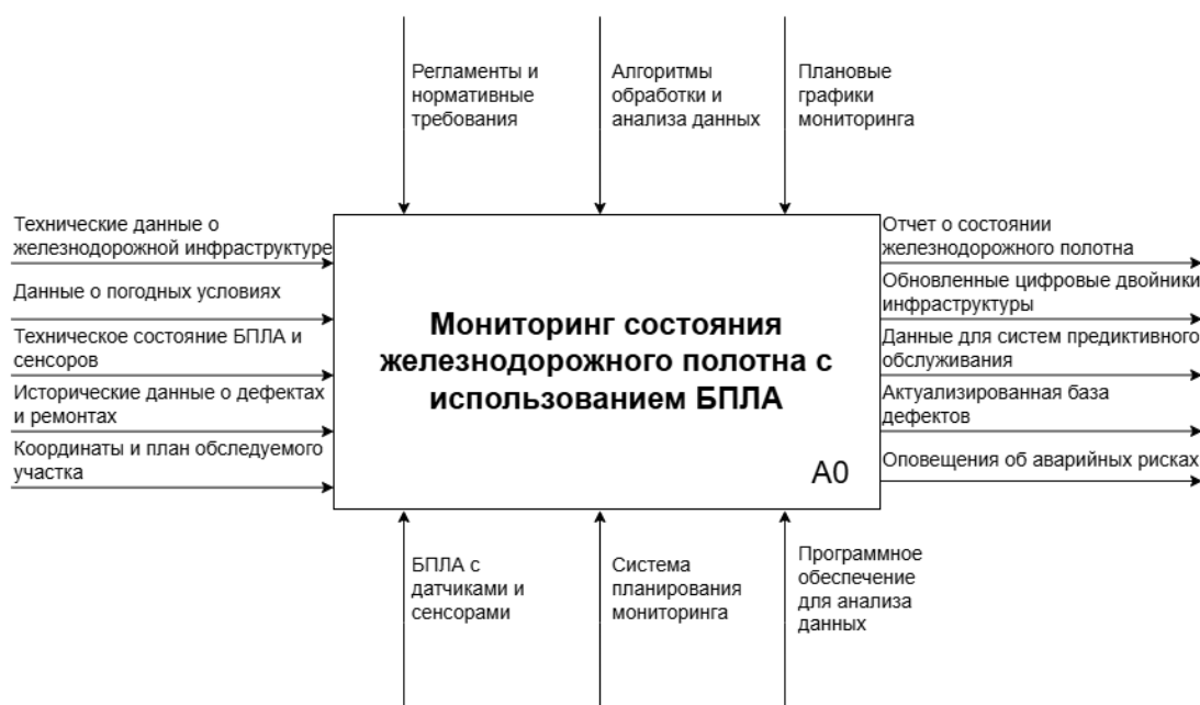
Рисунок 1 – Функциональный блок A0 «Мониторинг состояния железнодорожного полотна с использованием БПЛА»
