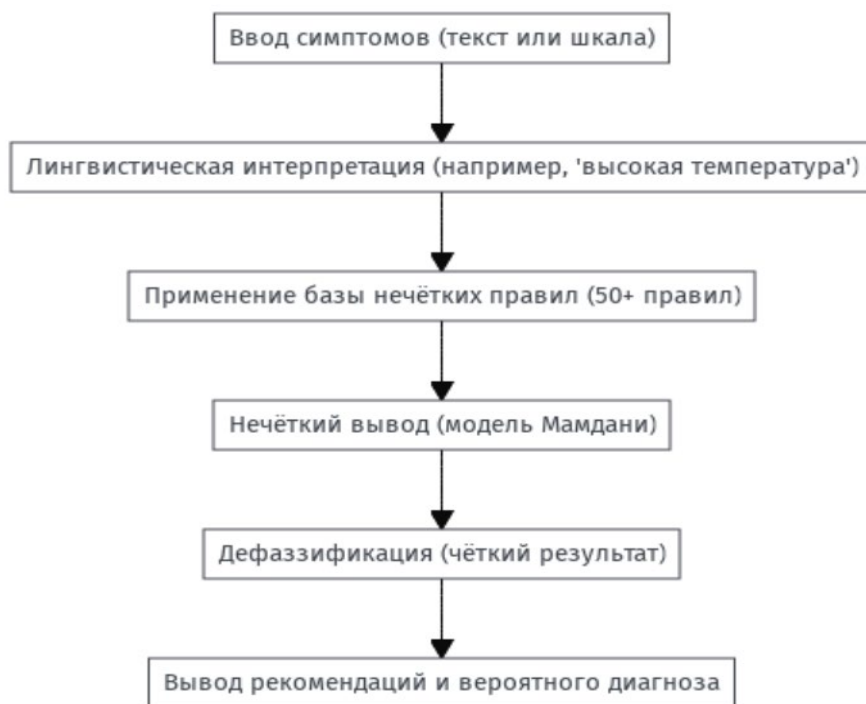
Рисунок 1 – Блок-схема алгоритма работы СППВР на основе нечеткой логики
