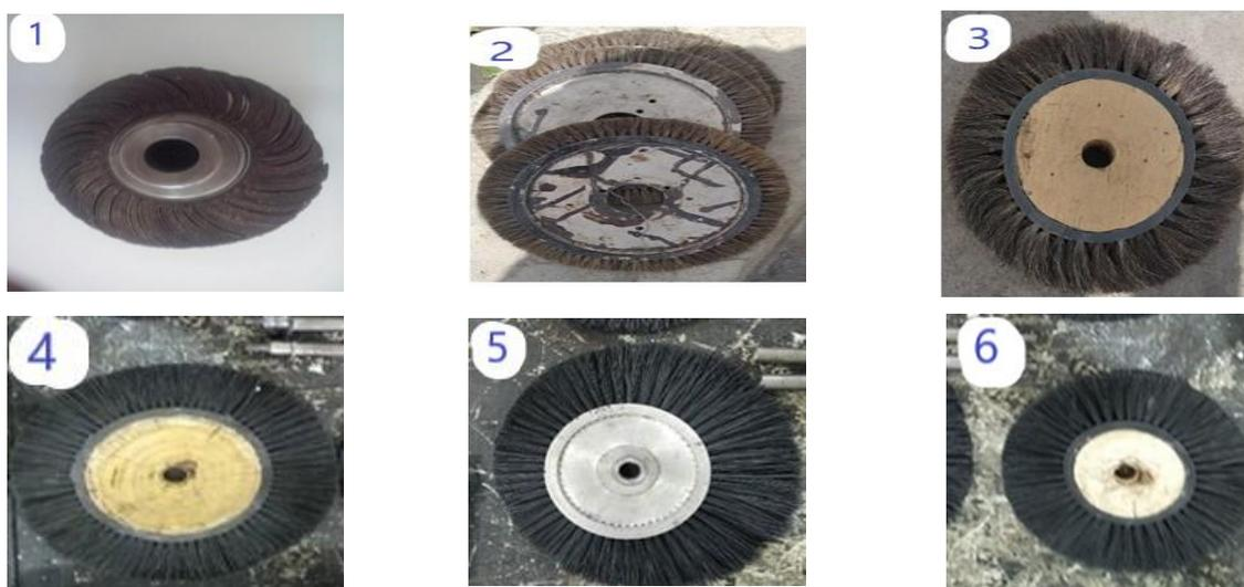
Рисунок 2 – Типы ротационных щёток с различным ворсом и с различным диаметром.
