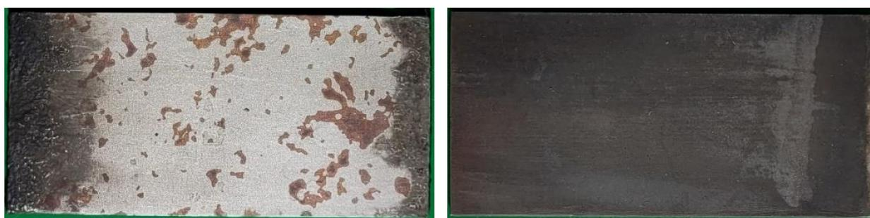
Рисунок 4 – Корродировавший и пассивированный образцы ГРОД ( $+50^{\circ}\text{C}$ )
