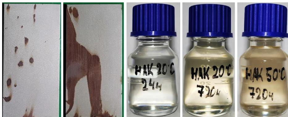
Рисунок 3 – НАК после 720 часов выдержки ( $+50^{\circ}\text{C}$ ). Изменение цвета среды НАК с повышением температуры до  $+50^{\circ}\text{C}$
