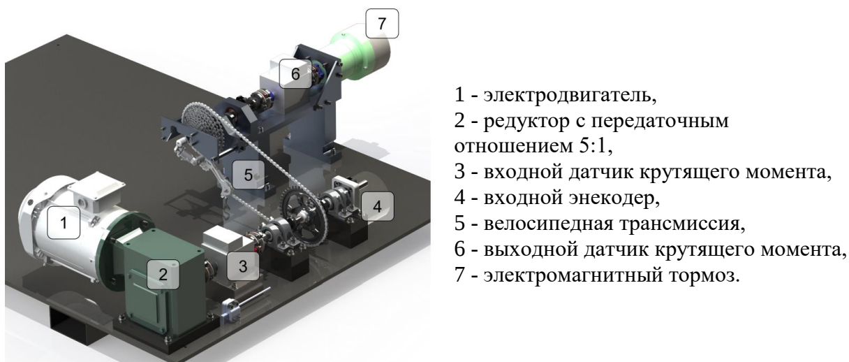
Рисунок 3 – Трехмерная модель испытательного стенда и его компонентов
