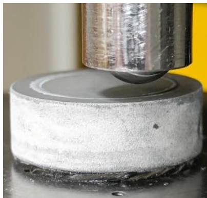
Рисунок 1 – Фотография диска с МДО-покрытием и WC-шариком в держателе
