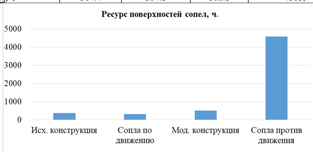
Рисунок 6 — Сравнение ресурса конструктивных модификаций сопел барабана центробежного декантера, в соответствии с рисунком 3
