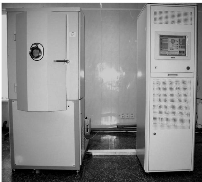
Рисунок 2 – Вакуумная установка «UNICOAT»
