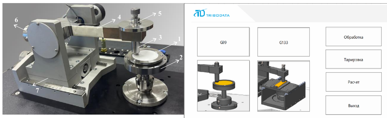
Рисунок 1 – Внешний вид машины трения (а) и окна управляющей программы (б).
