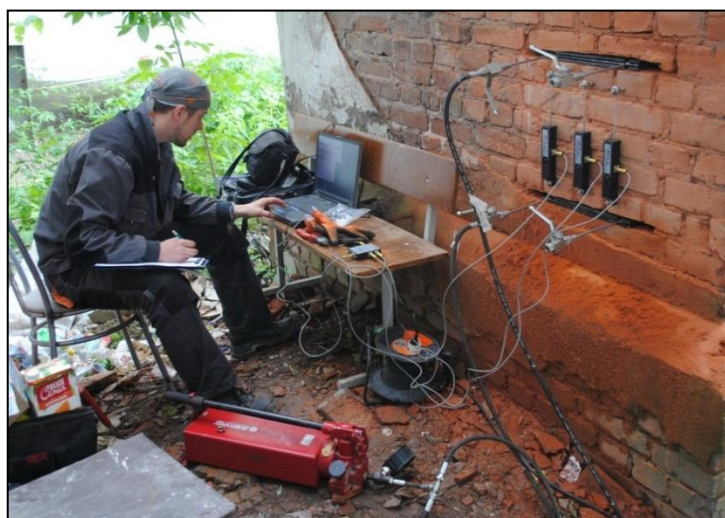
Рисунок 7. Испытание кирпичной кладки
