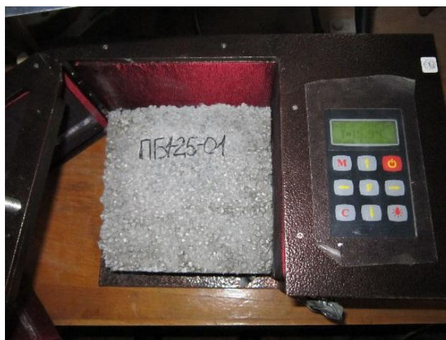
Рисунок 4. Испытание бетонных образцов на теплотехнические характеристики
