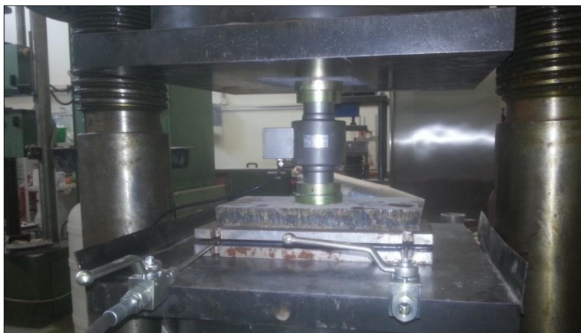
Рисунок 4. Определение жесткости домкрата
