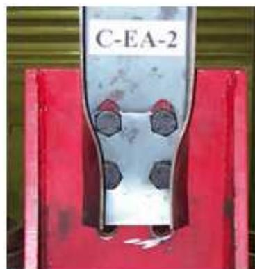
Рисунок 10. Характерный вид разрушения испытанных в [9] образцов
