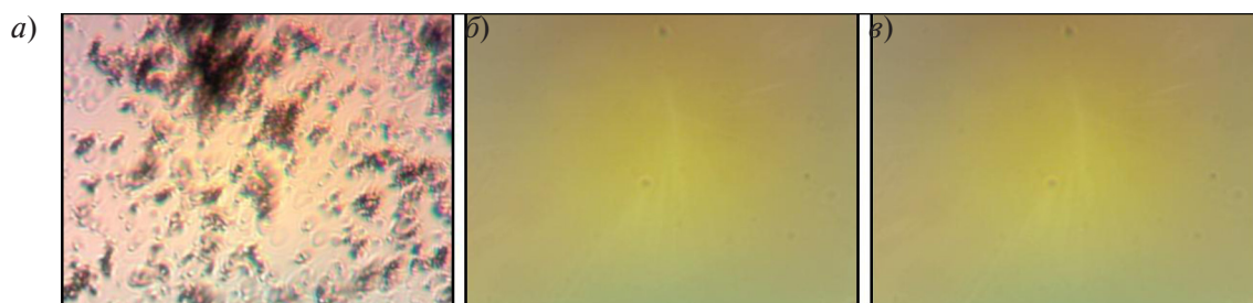
Рис. 4. Микрофотографии ( \times 400 ) проб трансформаторного масла марки ГК после термостарения при температуре 140 °С в течение 152 часов в контакте с медной спиралью (а), а также — с медной спиралью и ЭИБ из 100 % БЦ (б) и 100% РЦ (в)
