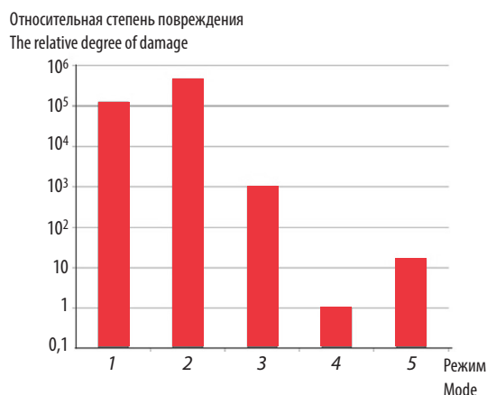
Рис. 3. Сравнительные ресурсные характеристики режимов эксплуатации. Режимы: 1 — холостой ход (SNL); 2 — малая частичная нагрузка (LPL); 3 — частичная нагрузка (PL); 4 — оптимум (BEP); 5 — большая нагрузка (HL)
