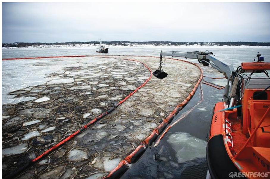
Рис. 1. Сбор разлитой нефти в ледовых условиях у берегов Норвегии
