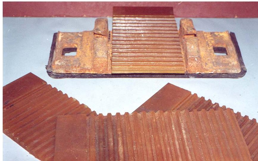
Рис. 7. Упругие прокладки и подкладки
