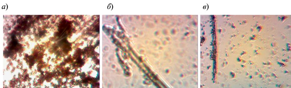
Рис. 5. Микрофотографии ( $\times 400$ ) проб трансформаторного масла марки ГК
