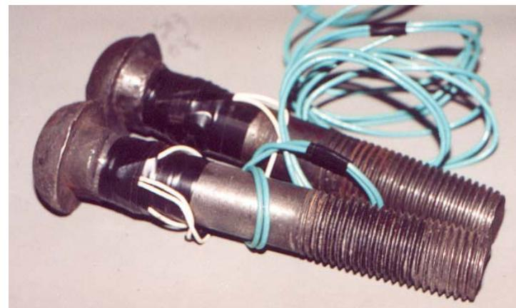
Рис. 3. Тензометрические болты
