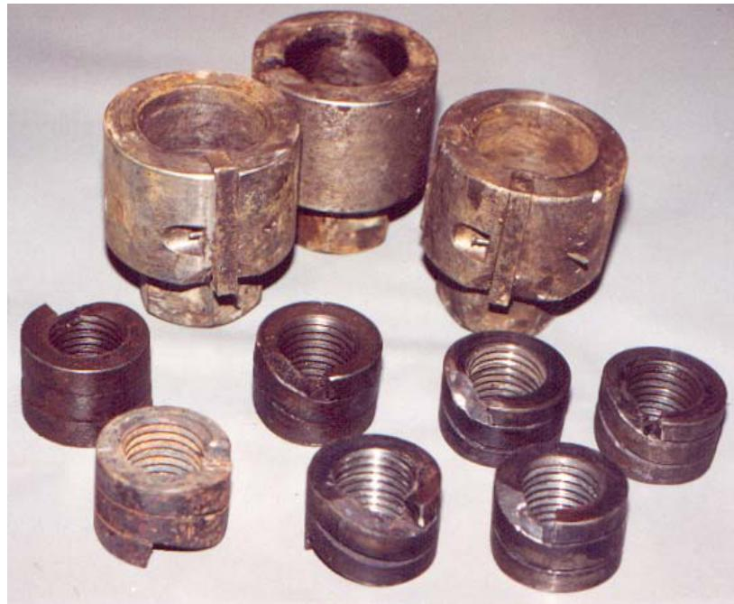
Рис. 1. Самозатягивающиеся гайки и головки ключей к ним
