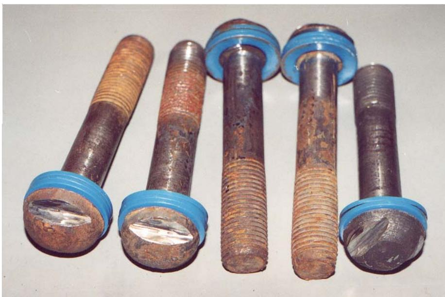
Рис. 8. Болты с энергоемкими упругими элементами (тарельчатые пружины)
