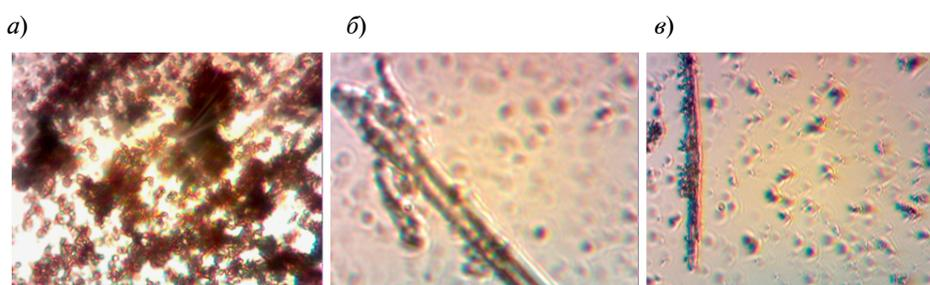
Рис. 5. Микрофотографии ( $\times 400$ ) проб трансформаторного масла марки ГК после 180 часов термостарения при температуре 140 °С с медным катализатором (а), а также в присутствии ЭИБ из 100 % ЭИЦ (б) и 100 % ЦГХ (е)
