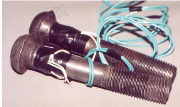
Рис. 3. Тензометрические болты
