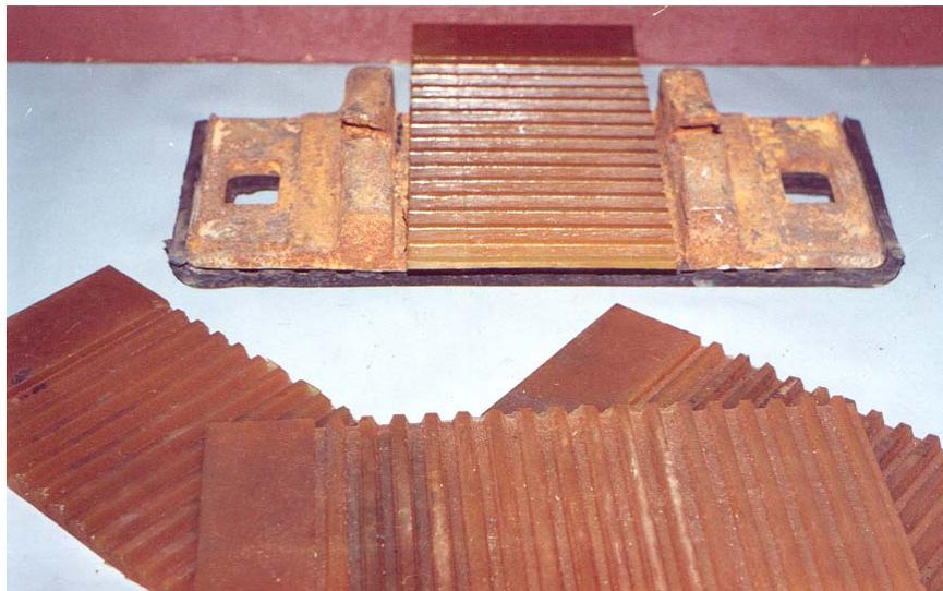
Рис. 7. Упругие прокладки и подкладки
