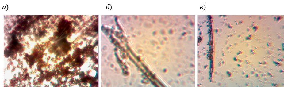
Рис. 5. Микрофотографии ( \times 400 ) проб трансформаторного масла марки ГК после 180 часов термостарения при температуре 140 °С с медным катализатором (а), а также в присутствии ЭИБ из 100 % ЭИЦ (б) и 100 % ЦГХ (е) Fig. 5. Microphotos ( \times 400 ) of the samples of transformer oil GK after 180 hours of thermal ageing at the temperature of 140 °C with copper catalyst (a); the same with traditional EIP (б) and with paper of 100 % CGX (e)
