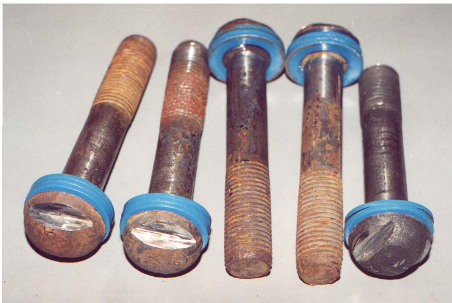
Рис. 8. Болты с энергоемкими упругими элементами (тарельчатые пружины) Fig. 8. Fish bolts with energy absorber elements (disk springs)
