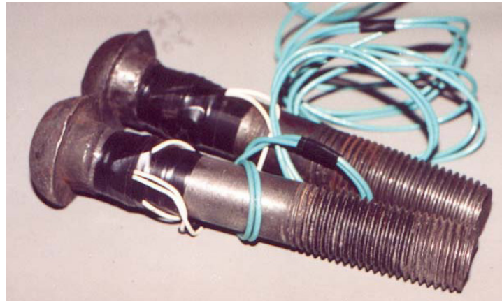
Рис. 3. Тензометрические болты Fig. 3. Strain gauge fish bolts
