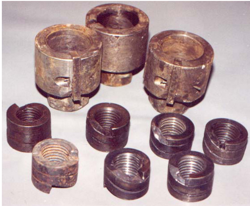
Рис. 1. Самозатягивающиеся гайки и головки ключей к ним Fig. 1. The self-joint nuts and heads of nut keys to them
