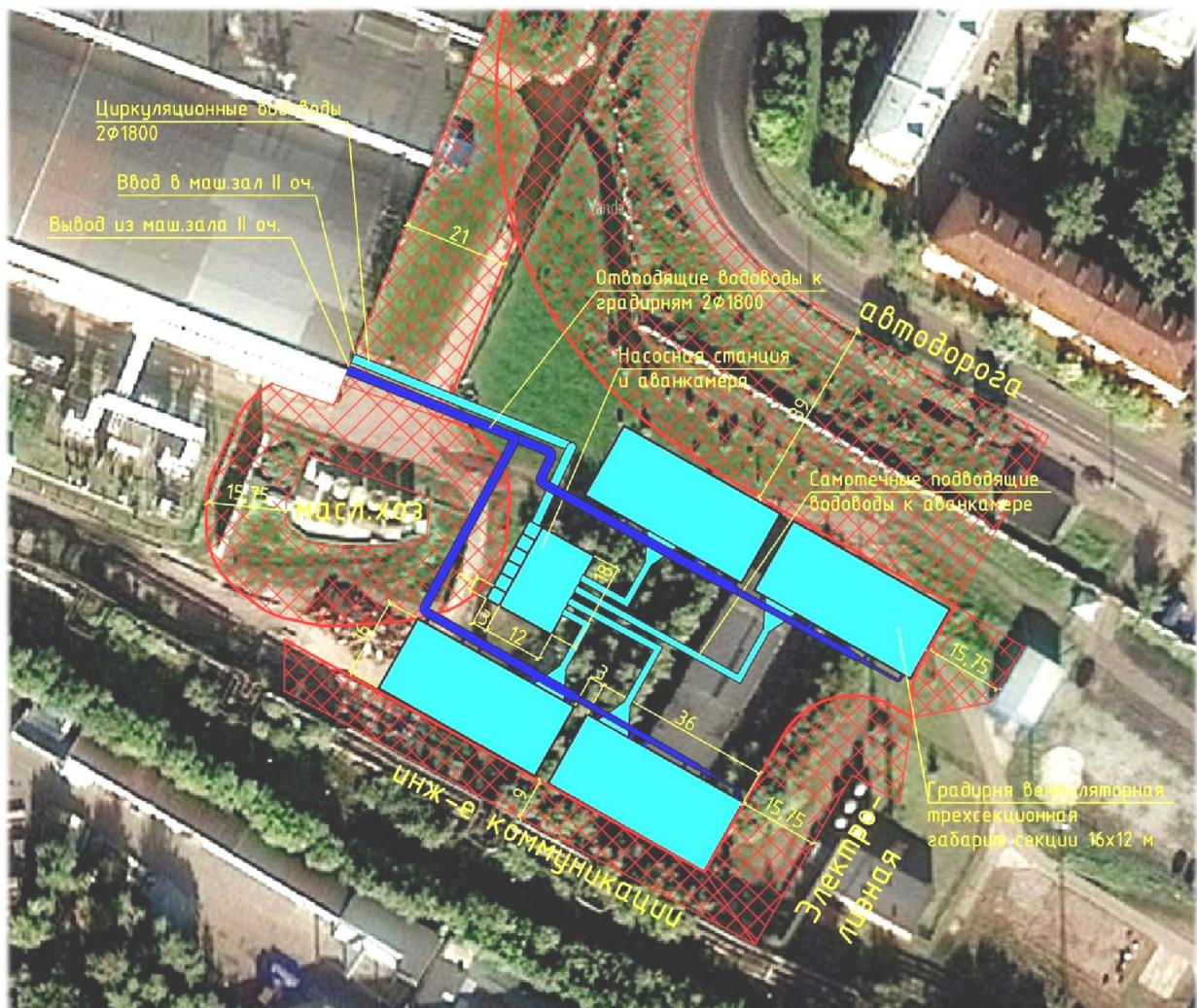
Рис. 2. Размещение вентиляторных градирен на генплане, вариант №2
